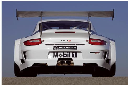
Der Entwicklungsschwerpunkt lag auf verbesserter Fahrbarkeit und einfacherem Fahrzeughandling. Angetrieben wird der 911 GT3 R von einem 4-Liter-Sechszylinder-Boxermotor mit 480 PS (353 kW). Die Kraft wird von einem sequentiellen Sechsganggetriebe an die Hinterachse übertragen. Die Entwicklungsbasis für den 1.200 kg leichten 911 GT3 R bildet der im September vorgestellte Markenpokal-Renner Porsche 911 GT3 Cup. Dank
