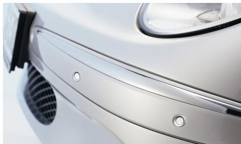
Dank neuester Ultraschalltechnologie und Absicherung der Fahrzeugecken erlaubt der Parkpilot eine lückenlose Hinderniserkennung bis zu einer Entfernung von 1,50 Metern. Selbst kleine Hindernisse wie niedrige Blumenkübel werden nach Unernehmensangaben sicher erfasst. Auch für Fahrzeuge mit Anhängerkupplung ist der neue Parkpilot geeignet.
