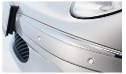
Dank neuester Ultraschalltechnologie Absicherung der und Fahrzeugecken erlaubt der Parkpilot eine lückenlose Hinderniserkennung bis zu einer Entfernung von 1,50 Metern. Selbst wie niedrige Blumenkübel Unernehmensangaben sicher erfasst. Auch für Fahrzeuge mit Anhängerkupplung ist der neue Parkpilot geeignet.
